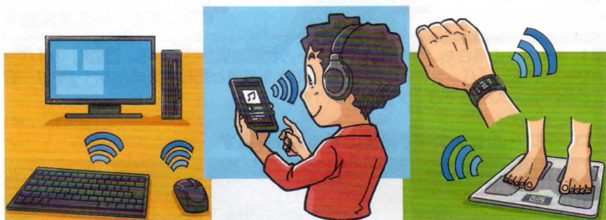
図1 Bluetoothは短距離、低速、低消費電力が特徴の無線通信規格。主にヘッドホンやマウス、キーボードといった周辺機器との接続に使われる
