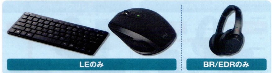
図4 子機になる機器はBR/EDRモードまたはLEモードの片方にしか対応しない場合が多い。例えば、LEモードにはオーディオ用のプロファイルがないため、ヘッドセットやイヤホンやスピーカーは基本的にBR/EDRモードを利用する
