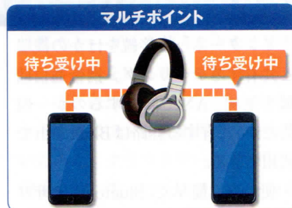
図17 マルチポイントに対応した機器は2台の親機と接続可能。例えば、パソコンで映画を見ているときにスマートフォンに着信があると自動で切り替わる
