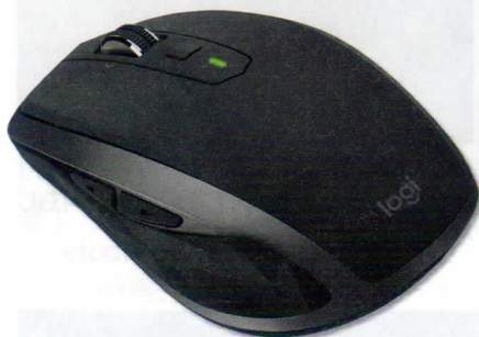
図1 Bluetoothを搭載したパソコンなら、USBアダプターなしで接続できる。小型のノートパソコンはUSB端子が少ないため便利
