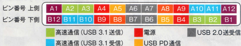
図2 高速通信用の信号線が4組あり、標準でUSB 3.1が2組利用しているが、Alt ModeではここにUSB以外の信号も流せる
