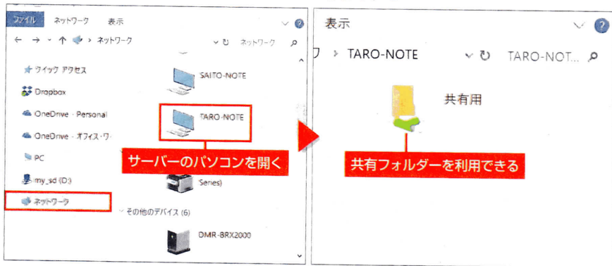
図10 エクスプローラー画面の左の一覧から「ネットワーク」を選ぶと、サーバーとなっているパソコンの一覧が表示されるので、相手をダブルクリック(左)。共有フォルダーが表示される(右)
