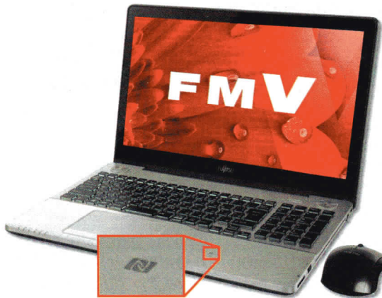
図20 富士通の「FMV LIFEBOOK AH90/B1」は、パームレスト右側にNFCを内蔵。タッチ位置がロゴマークで示されている
