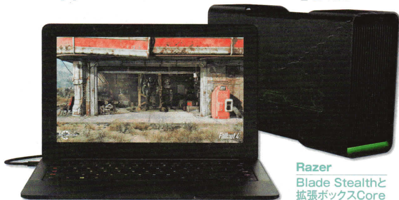
図13 Type-Cに対応した「Thunderbolt 3」を利用すると、スリムなノートパソコンでもケーブル一本で拡張ボックスと接続し、PCI Expressカードスロットや各種端子を増設できる
