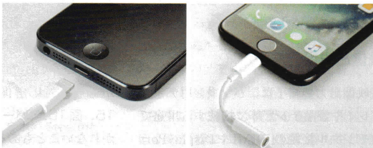
図B iPhoneは、Apple独自のLightning端子を採用している。端子が小さく裏表どちら向きでも挿抜できる。iPhone 7ではヘッドホンの接続にも使う
