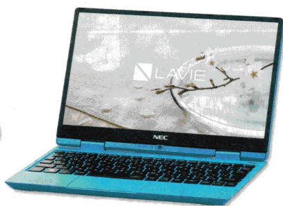
図13 ノートパソコンは狭額縁にすると本体をひと回り小さくできる(NEC、LAVIE Note Mobile NM550/GA)
