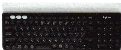
図19 ロジケールの「K780」。最大3台のペアリング情報を記憶し、専用キーで瞬時に接続先を切り替えられる
