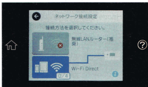
図11 Wi-Fi対応のプリンターは、アクセスポイントなしでパソコンなどと接続するため、「Wi-Fi Direct」に対応していることが多い
