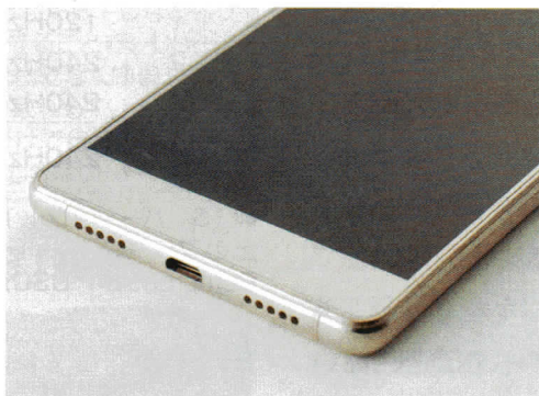
図A AndroidスマートフォンではMicro-USB端子を搭載する機種が多いが、徐々にType-C端子に切り替わりつつある。多くの端末がホストモードもサポートしている
