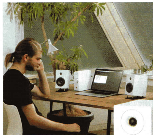
図15 パソコンをハイレゾ対応にするには、データを処理できる「DAC (digital to analog converter)」と、高い周波数も再現可能なスピーカーが必要だ。ソニーの「CAS-1」はUSB接続のDAC兼オーディオアンプとスピーカーのセット
