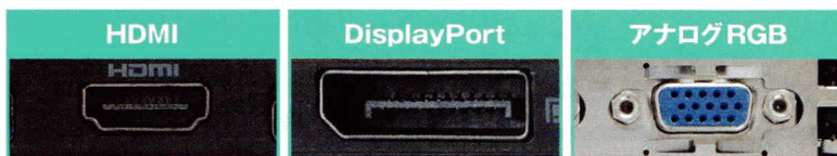
図14 パソコンの映像出力には、主にHDMIやDisplayPortが利用されるが、ビジネス機は古いプロジェクターに接続するためアナログRGB端子を備えることも多い
