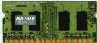
図12 「SO-DIMM」と呼ばれる小型のモジュール。DDR4とDDR3では、ピン数や切り欠きの位置が異なる
