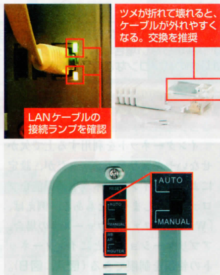
図6 ケーブル類に緩みがないか確認する。ルーターなどのモード切り替えスイッチがズレている場合は、正しく設定してから再起動する
