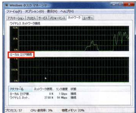
図1 タスクマネージャーで通信に使っているアダプターを調べる。アダプター名に「ローカルエリア接続」とあるのが有線LANだ。
