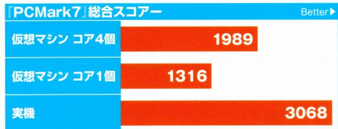
↑「PCMark7」を使用。CPUはCore i7-3770 (3.4GHz)。ホスト、ゲストともにWindows8で計測。仮想マシン4個に設定するとパフォーマンスが大きく向上した。
