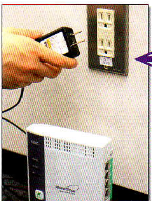
図7 自動設定に対応していても適切なチャンネルが設定されていないことがある。その場合は電源コードを抜き挿しして親機を再起動するとチャンネルが再設定される。
