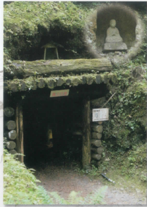
ひおい坑 岩石の隙間に板のように固まっている鉱物の層(鉱脈)を追って掘り進んだ小さな坑道を「ひおい坑」と言います。
