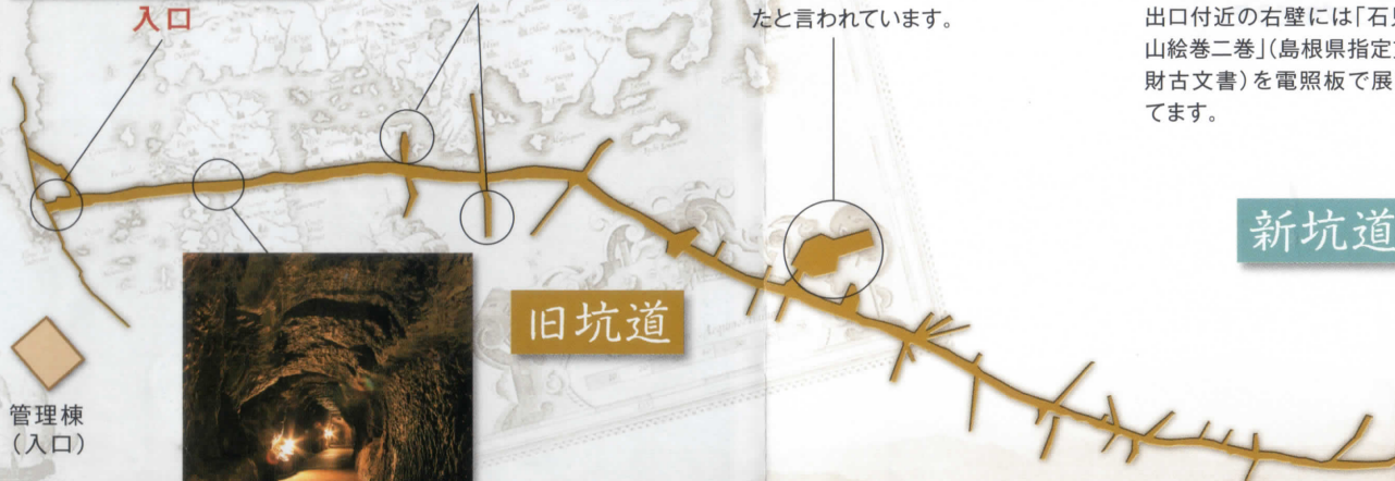
ひおい坑 岩石の隙間に板のように固まっている鉱物の層(鉱脈)を追って掘り進んだ小さな坑道を「ひおい坑」と言います。
