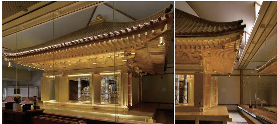
金色堂の外観 堂外観全体を覆った金箔の輝きを上下に配置したLEDライン器具(カスタム品)により一層の美しさを引き出している
