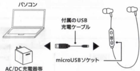
付属のUSB充電ケーブルを本商品のmicroUSBソケットへ挿して下さい。パソコンに接続するか、AC/DC充電器等に接続すると充電が開始されます。
