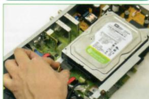
液晶パネルと、HDDの横に設置してある無線LANユニットを外す。次に純正HDD（Western Digital「WD5000AVCS」）の台座に付けられているネジを取り、SATAケーブルと電源ケーブルを抜く
