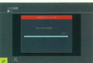
1 書き換えが終わったら、HDDを本体に接続。取り外した時の作業の逆を行えばよい。2次にレコーダーにHDDを認識させるためのフォーマット。レコーダーをテレビにつなげ、メニュー画面の「初期設定」を選び、さらに「HDD/ディスク/USB-HDD設定」→「HDD設定」→「HDD管理」→「HDDのフォーマット」と進む。HDDのフォーマット画面が表示されるので、「はい」を選択すればOKだ
