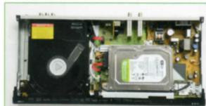
プラスドライバーなどを使い、ボディに止められているネジを外し、天板を取る
