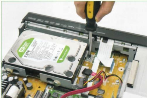
換装用のHDD（2TBタイプか1TBタイプ）を台座に設置。電源ケーブルとSATAケーブルをHDDに挿入し、天板を元通りに取り付ける
